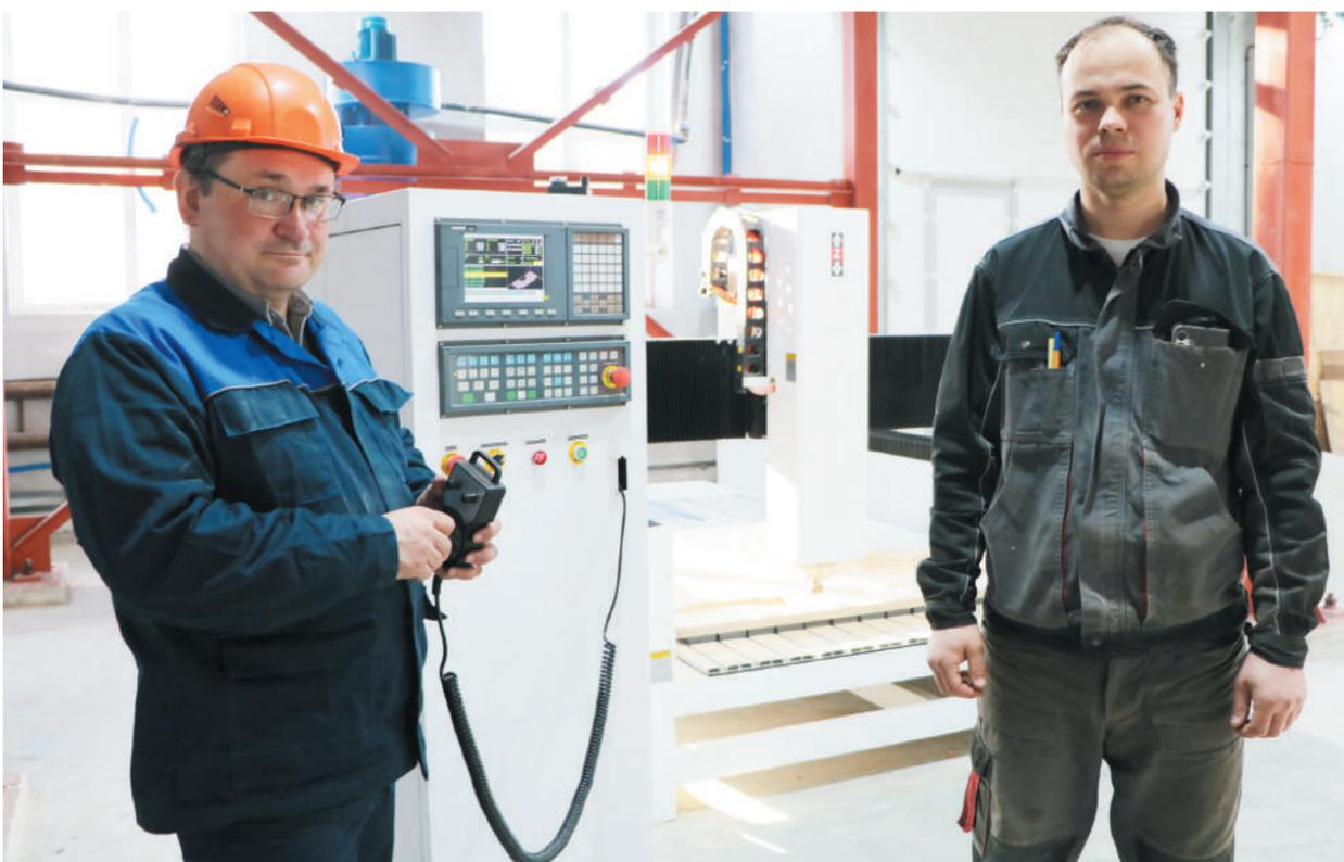
Новый фрезерный станок установили на модельном участке литейного цеха Асбестовского Ремонтно-Машиностроительного завода. На современном оборудовании можно изготавливать любые модели из ассортимента продукции «литейки» - достаточно загрузить в программу 3D-модель будущего изделия.
