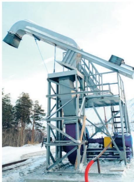
Опытная установка для выдувания снега из полувагонов
