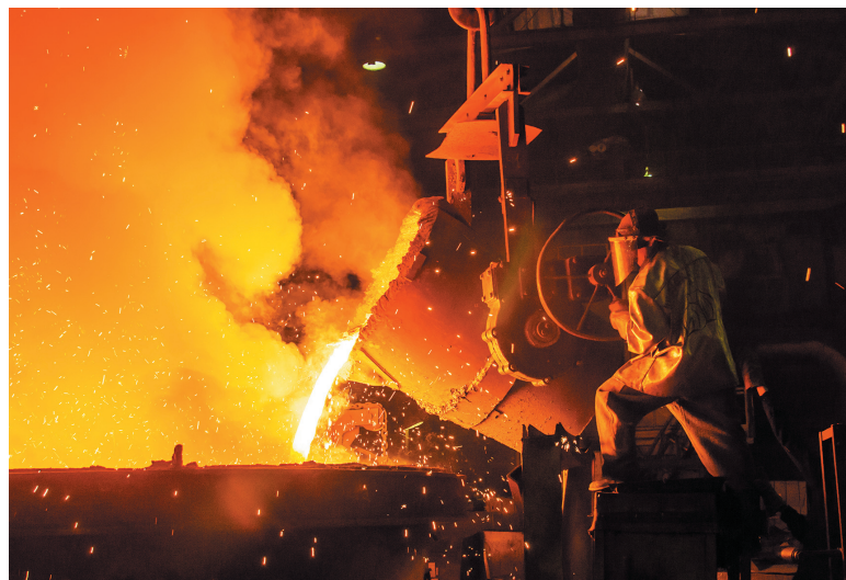
Температура металла в печах литейного цеха Асбестовского ремонтно-машиностроительного завода достигает 1600 градусов по Цельсию.
