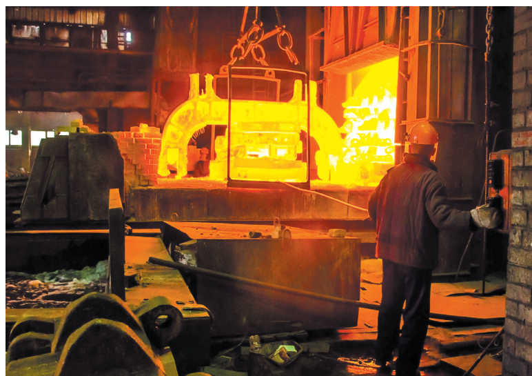
Закалка коромысла ковша для экскаватора ЭКГ-8 во время термообработки. Через несколько мгновений эта деталь окажется в воде.
