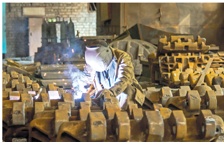
Электросварщик дорабатывает траки для экскаватора ЭКГ-8 - готовит их к сдаче на технический контроль.
