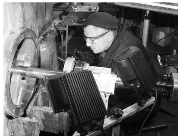
Работник цеха № 1 токарь Юнус ГАФУРОВ растачивает посадочные места для подшипников в щитах синхронного электродвигателя шагающего экскаватора.
