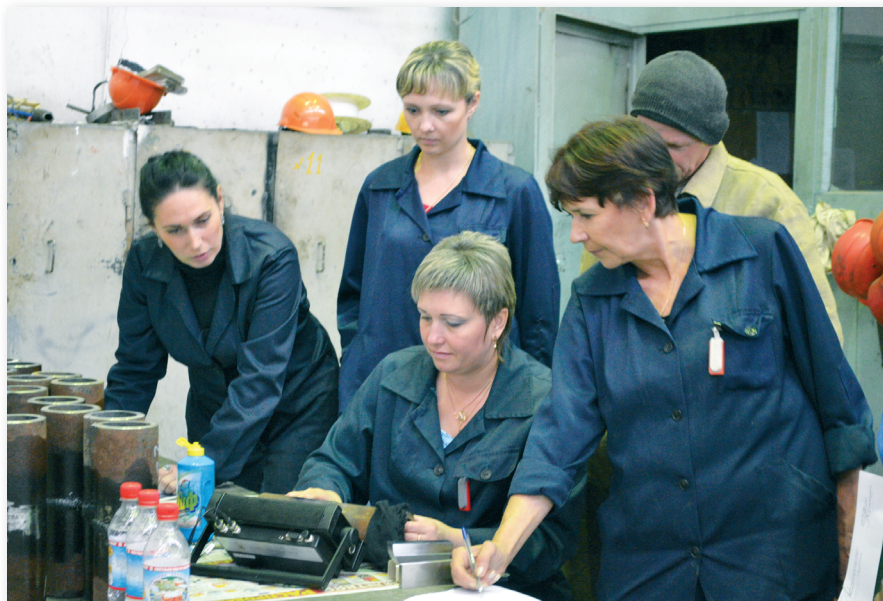
Дефектоскопист Ирина СТОРОЖКОВА (в центре) проверяет качество сварных швов.
