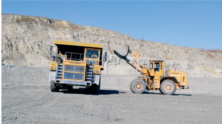
Автопогрузчик загружает 55-тонный БелАЗ щебнем для его попутной перевозки и использования при выполнении дорожных работ.
